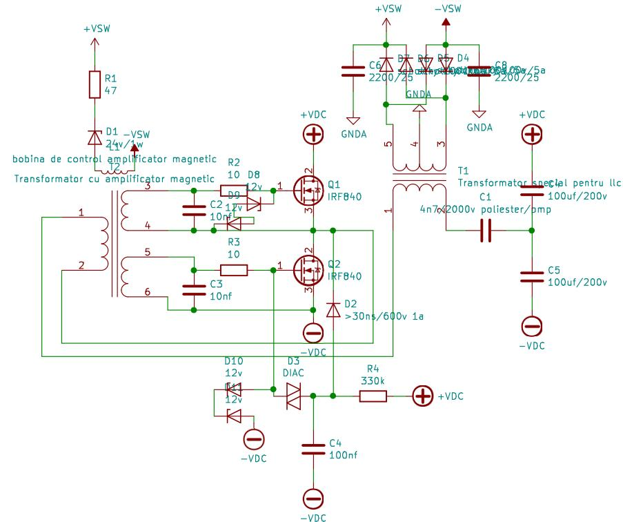
Transformatorul original cu amplificator magnetic de la Sony modificat cu care 10 spire pe poarta mosfet, in rest nemoneditat, atentie are o folie de plastic pentru intrefier, nu o pierdeti, se poate realiza si pe o oala mica de ferite cu gaura.
